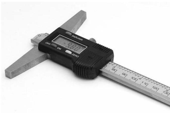
Штангенглубиномер с цифровым индикатором типа ШГЦ предназначен для измерения глубин. Оснащен цифровым индикатором, с помощью которого быстро и удобно снимать показания. Электронный блок позволяет производить переключения систем измерения мм/дюйм, выставлять нулевое значение в любом желаемом месте, выводить данные на внешний носитель.
