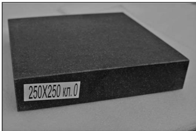
Плита поверочная гранитная служит для проверки плоскостности поверхностей по методу "пятен на краску" и "линейных отклонений" и используется в качестве вспомогательного приспособления при поверочных и контрольных работах. Изготавливаются 0 и 00 классов точности с шаброванной рабочей поверхностью.
