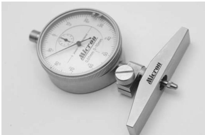
Глубиномеры индикаторные типа ГИ предназначены для измерения глубины пазов, отверстий и высоты уступов. Оснащены индикатором часового типа. Диапазон измерения обеспечивают набор сменных измерительных стержней, оснащенных твердым сплавом. У ГИ-100 девять стержней, у ГИ-150 четырнадцать стержней.
