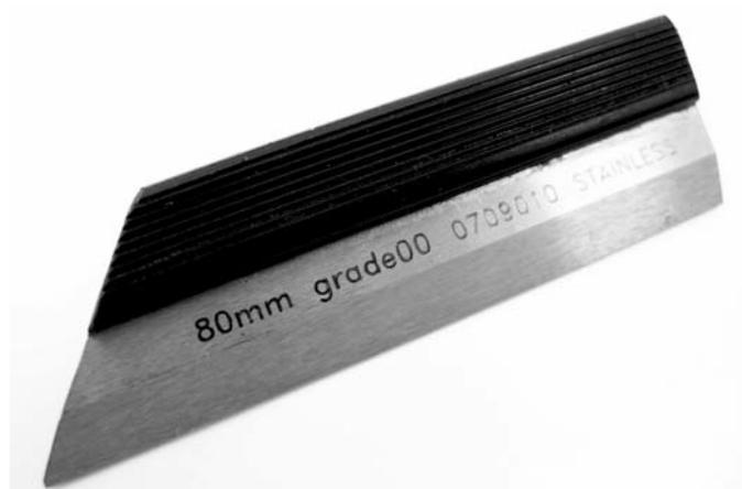
Линейки поверочные лекальные с двусторонним скосом типа ЛД применяются для проверки плоских поверхностей методом световой щели - на просвет, непосредственно определяемый на глаз, либо сравнением с образцом просвета, а так же методом определения линейных отклонений при помощи линейки и плиток, щупов или плиток в сочитании с рычажным индикатором. Снабжены термоизоляционной накладкой.
