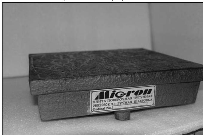
Плита поверочная служит для проверки плоскостности поверхностей по методу "пятен на краску" и "линейных отклонений" и используется в качестве вспомогательного приспособления при поверочных и контрольных работах. Изготавливаются 1 и 2 классов точности, а также в двух исполнениях - с ручной шабровкой или механической обработкой рабочей поверхности.
