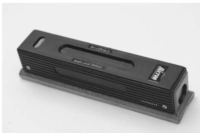
Уровни брусковые предназначены для контроля горизонтального расположения плоских и цилиндрических поверхностей, а также прямолинейности и плоскостности горизонтально расположенных плоских и цилиндрических поверхностей с высокой точностью. Отсчет - по штрихам ампулы. Устройство выставления на ноль. Опорная поверхность изготовлена в виде призмы.
