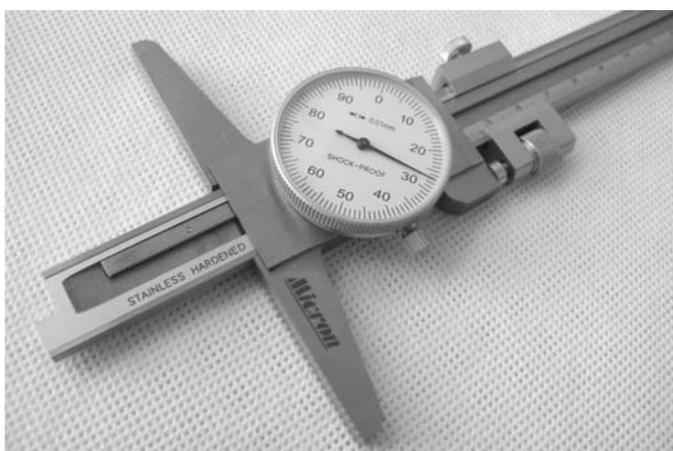
Штангенглубиномеры со стрелочным индикатором типа ШГС позволяют выполнять высокоточные измерения глубин. Стрелочный индикатор является удобным инструментом в руках специалиста. В частности имеется возможность выставления нулевого значения в любом положении и измерение отклонений размеров. Снабжен устройством тонкой подачи.
