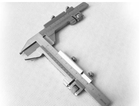
Штангензубомеры типа ШЗН предназначены для измерения толщины зуба зубчатого колеса на расчетной глубине и представляют собой сочетание штангенглубиномера и штангенциркуля. Вертикальная линейка штангензубомера предназначена для установки высоты от вершины зуба, на которой производится измерение толщины зуба, а горизонтальное устройство предназначено для непосредственного измерения толщины зуба. Штангензубомер может быть использован для измерения толщины зуба колес с модулем до 26.
