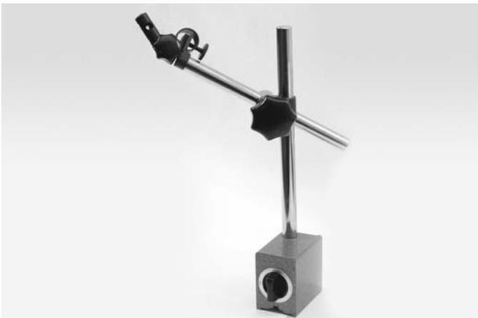
Штатив для измерительных головок типа ШМ-II-Н имеет магнитное основание и низкую колонку, используется для измерительных головок с ценой деления 0,01мм и более. Диаметр отверстия под измерительную головку 8 Н8. Включение/выключение магнита осуществляется поворотом ручки. По цилиндрической колонке движется муфта со стержнем с закрепленной на конце измерительной головкой. Штатив имеет устройство для точной установки на размер.
