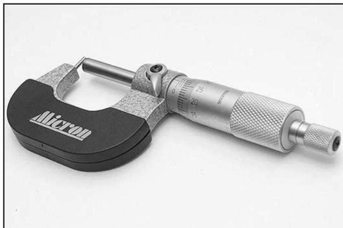
Микрометрами трубными типа МТ измеряют толщину стенок труб. Измерительная поверхность пятки выполнена в виде стержня со сферой, диаметром 4,7 мм, расположенного перпендикулярно перемещению стебля микрометрической головки. Измерительные поверхности оснащены твердым сплавом.
