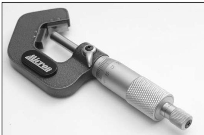
Призматические микрометры служат для измерения наружного диаметра многолезвийного инструмента, а именно: модель МПИ с углом призмы 108° - для пятилезвийного инструмента. В комплект микрометра входит установочная мера. Измерительные поверхности оснащены твердым сплавом.
