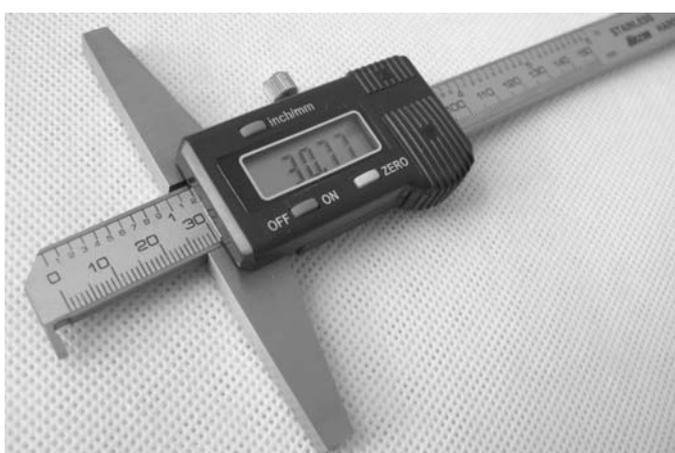
Штангенглубиномером типа ШГЦС можно производить измерения расположения труднодоступных канавок, других толщин, невозможные ординарным инструментарием. Отсчет показаний осуществляется по цифровой шкале. Цифровой блок позволяет устанавливать ноль в любом положении.
