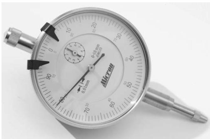
Индикатор часового типа ИЧ предназначен для измерения линейных размеров как абсолютным, так и относительным методами, а также определения величины отклонений от заданной геометрической формы и взаимного расположения поверхностей. Для крепления индикаторов в стойках или посадочных местах измерительных приборов предназначены присоединительная гильза диаметром 8h7 или ушко толщиной 5 мм с отверстием диаметром 5 мм.
