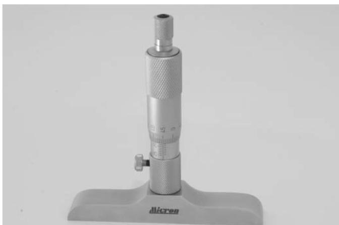
Глубиномеры микрометрические типа ГМ предназначены для измерения глубины пазов, отверстий и высоты уступов. Диапазон измерения обеспечивает набор сменных удлинительных стержней, оснащенных твердым сплавом. У ГМ-50 два сменных стержня, у ГМ-100 - четыре, у ГМ-150 - шесть стержней. Отсчет осуществляется по шкалам стебля и барабана микрометрической головки. Для обеспечения постоянства измерительного усилия микрометрическая головка снабжена трещоткой.
