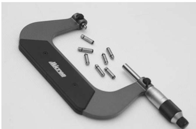
Микрометры со сменными вставками типа MBM предназначены для измерения среднего диаметра метрической резьбы. В комплекте имеется установочная мера и вставки для контроля метрической резьбы. Отсчет осуществляется по шкалам стебля и барабана.
