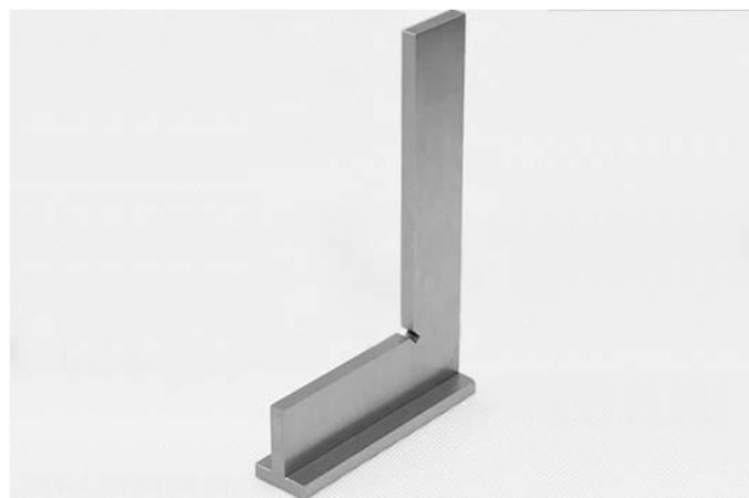
Угольники слесарные с широким основанием типа УШ предназначены для проверки прямых углов (90°) и применяются при слесарно-сборочных работах для контроля взаимно перпендикулярного расположения деталей. Имеют плоские измерительные поверхности и широкое опорное основание. Изготавливаются из нержавеющей стали.
