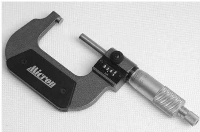
Микрометры гладкие типа МКЦМ предназначены для измерения наружных размеров изделий. Измерительные поверхности оснащены твердым сплавом. Микрометры комплектуются установочной мерой. Индикация показаний при измерении производится по шкале барабанного типа - цифрам механических бегунков, расположенным на стебле микрометрической головки, что существенно облегчает считывание значений. Также считывание может осуществляться по шкалам стебля и барабана.
