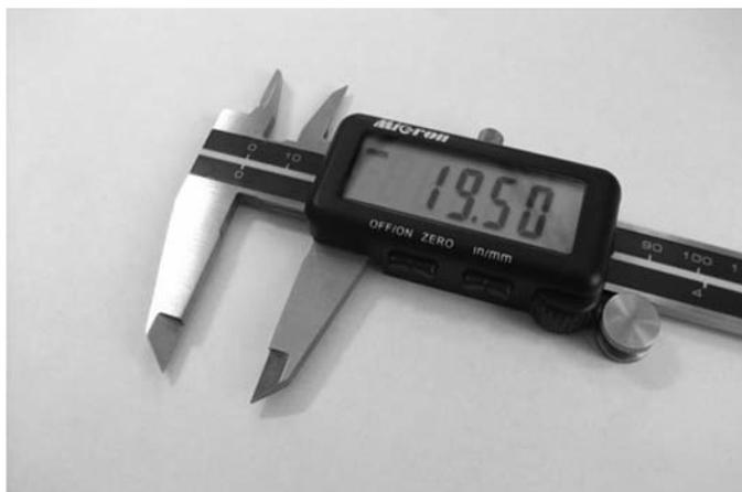
Штангенциркули с большим цифровым индикатором типа ШЦЦБ-1 согласно типу имеют внешние и внутренние губки и глубиномер. Увеличенный цифровой индикатор существенно облегчает считывание показаний, что весьма удобно при проведении измерений. Влагопылезащитное исполнение IP45.
