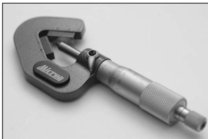
Призматические микрометры служат для измерения наружного диаметра многолезвийного инструмента, а именно: модель МТИ с углом призмы 60° - для трехлезвийного инструмента. В комплект микрометра входит установочная мера. Измерительные поверхности оснащены твердым сплавом.
