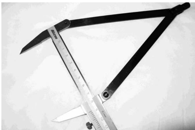
Штангенциркули разметочные типа ШЦР предназначены для проведения разметочных работ на различных поверхностях. Оснащены удобной циркульной системой развода губок. Губки закаленные или твердосплавные.
