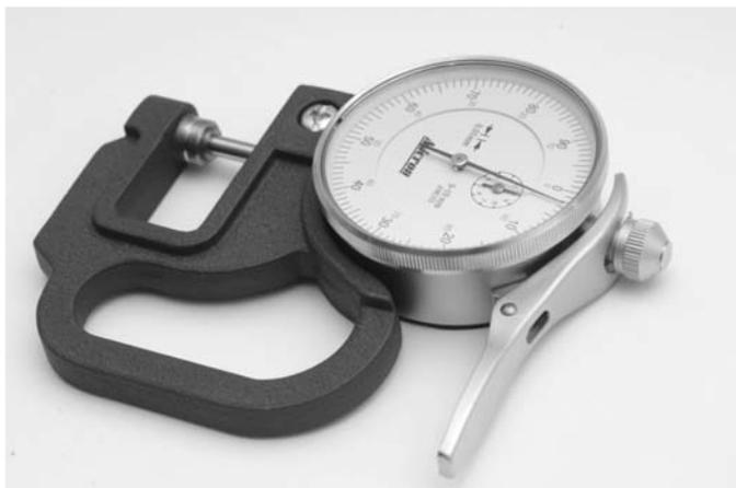
Толщиномеры ручные типа ТР с нормированным измерительным усилием предназначены для измерения толщины тонких/листовых материалов. Считывание показаний производится по многооборотному индикатору часового типа. Цена деления 0,01 мм. Диапазон измерений 0-10 мм. Вылет корпуса 30, 60 или 120 мм (зависит от исполнения).
