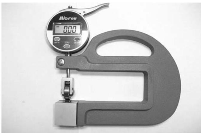
Толщиномеры ручные роликовые типа ТРЛ с нормированным измерительным усилием предназначены для измерения толщины тонких/листовых материалов, находящихся в движении. Считывание показаний производится по цифровому индикатору, что существенно облегчает процесс измерения. Цена деления 0,01 мм. Диапазон измерений 0-10 мм. Вылет корпуса 30, 60 или 120 мм (зависит от исполнения).
