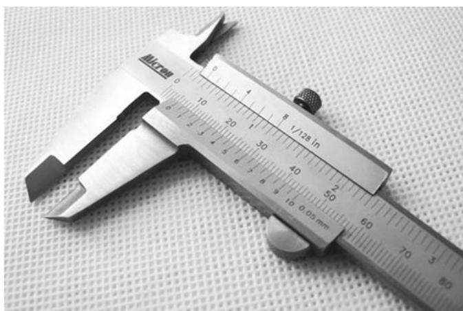
Штангенциркули типа ШЦ-1 с моноблочной конструкцией нониусной рамки характеризуются повышенным качеством исполнения и большей долговечностью. Рекомендуются пользователям, предъявляющим повышенные требования к качеству измерений. Нержавеющая сталь. Наружные и внутренние губки, встроенный глубиномер. Выпускаются классов 1 и 2.
