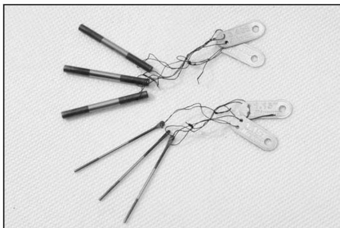
Проволочки и ролики применяются для измерения среднего диаметра наружной резьбы, а также измерения толщины зубьев и ширины впадин шлицевых валов и втулок с эвольвентным профилем. Предназначены для контроля среднего диаметра резьбы методом трех проволочек. Диаметр проволочек и роликов Вы можете подобрать из предлагаемого ряда или заказать уникальный диаметр для Ваших нужд.
