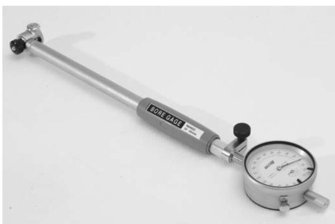
Нутромеры индикаторные повышенной точности типа НИ-ПТ предназначены для измерения внутренних размеров изделий двухточечным контактом с измеряемыми поверхностями относительным методом. Отсчетное устройство - индикатор часового типа. На измерение требуемого размера нутромер настраивается с помощью одного из входящих в комплект сменных стержней. Настройка производится по аттестованным кольцам или блокам концевых мер длины с боковиками.
