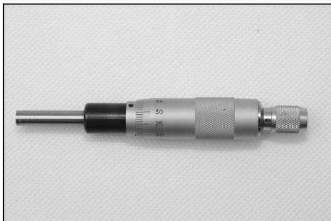
Головки микрометрические типа МГ предназначены для измерения перемещения с высокой точностью. Головка встраивается в ручные и стационарные измерительные приборы и измерительные средства. Гладкий выдвижной шток - с плоской пяткой, оснащен твердым сплавом. Присоединительные размеры: диаметр 12h7, длина 17 мм. Диаметр выдвижного штока 6,5 мм. Вылет штока от 3 до 28 мм. Общая длина 115 мм.
