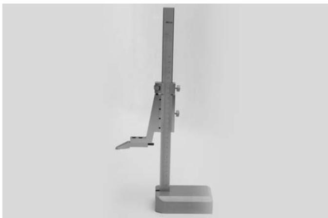
Штангенрейсмасы типа ШР предназначены для выполнения измерений и разметки различных деталей в машиностроении. Штанга прибора имеет миллиметровую шкалу. Отсчет показаний производится по нониусу. Для облегчения установки на требуемый размер рамка оснащена устройством тонкой настройки (с микрометрическим винтом).
