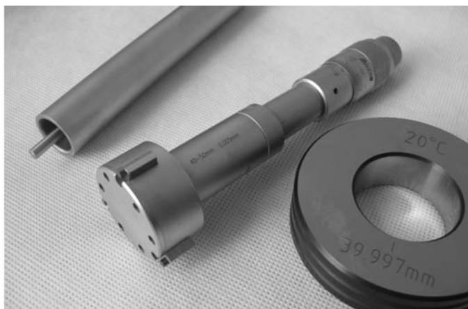
Нутромеры трёхточечные типа НМТ с реализованной с помощью микрометрической шкалы стебля и барабана системы считывания значений. Предназначены для особо точных измерений проходных, глухих отверстий, центрирующих кромок. Головка - самоцентрирующаяся. В комплект поставки входят удлинитель, установочное кольцо, алюминиевый кейс.
