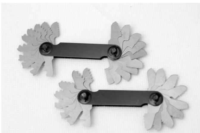
Шаблоны резьбовые предназначены для определения номинального шага метрической резьбы (набор М 60°) и числа ниток (витков резьбы) на один дюйм (набор Д 55°). Изготавливаются три набора резьбовых шаблонов. Конструкция обоймы набора обеспечивает возможность свободной замены любого шаблона, а также регулирование плавности вращения их на оси.
