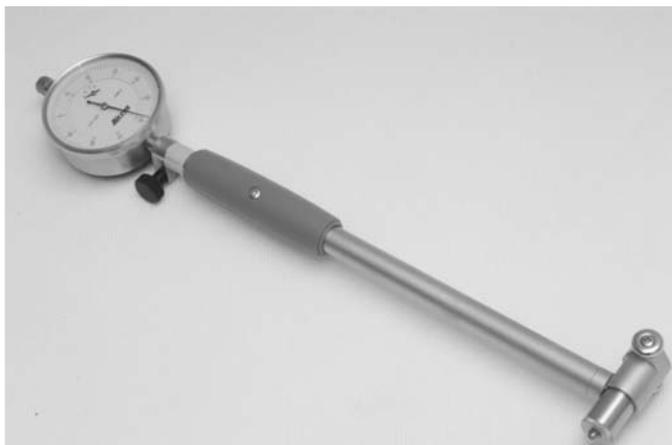
Нутромеры индикаторные типа НИ предназначены для измерения внутренних размеров изделий двухточечным контактом с измеряемыми поверхностями относительным методом. Отсчетное устройство - индикатор часового типа. На измерение требуемого размера нутромер настраивается с помощью одного из входящих в комплект сменных стержней. Настройка производится по аттестованным кольцам или блокам концевых мер длины с боковиками.
