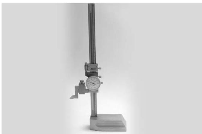
Штангенрейсмасы типа ШРК предназначены для выполнения измерений и разметки различных деталей в машиностроении. Штанга прибора имеет миллиметровую шкалу. Отсчет показаний производится по круговой шкале индикатора. Оснащены устройством тонкой подачи.
