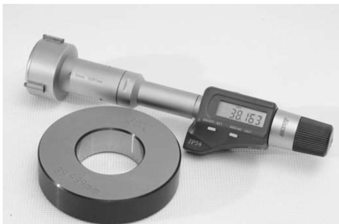
Нутромеры трехточечные типа НМТЦ с реализованной с помощью цифрового индикатора системы считывания значений. Предназначены для особо точных измерений проходных, глухих отверстий, центрирующих кромок. Головка - самоцентрирующаяся. Измерительные шупы упрочнены твердым сплавом. Могут применяться для абсолютных и относительных измерений.
