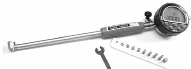
Нутромеры индикаторные электронные повышенной точности типа НИЦ-ПТ предназначены для измерения внутренних размеров изделий двухточечным контактом с измеряемыми поверхностями относительным методом. Отсчетное устройство - электронный цифровой индикатор. На измерение требуемого размера нутромер настраивается с помощью одного из входящих в комплект сменных стержней. Настройка производится по аттестованным кольцам или блокам концевых мер длины с боковиками.
