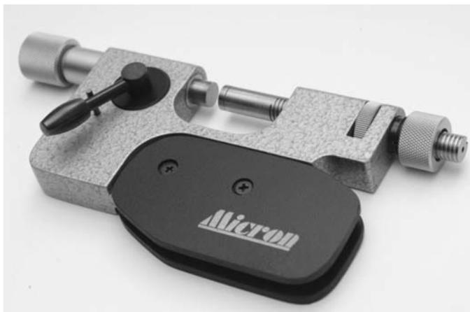
Скобы индикаторные с внешним съёмным индикатором типа СИ предназначены для универсальных линейных измерений наружных размеров методом сравнения. Продольно перемещаемый измерительный щуп отводится обратно рычагом отвода. Противоположный щуп - точно регулируемый. Измерительные поверхности щупов твердосплавные. Скоба имеет теплоизолированные накладки. Устройство обеспечивает постоянное измерительное усилие, что важно для повторяемости измерений.
